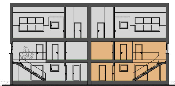
Prikaz objekta (vzdolžni prerez)
